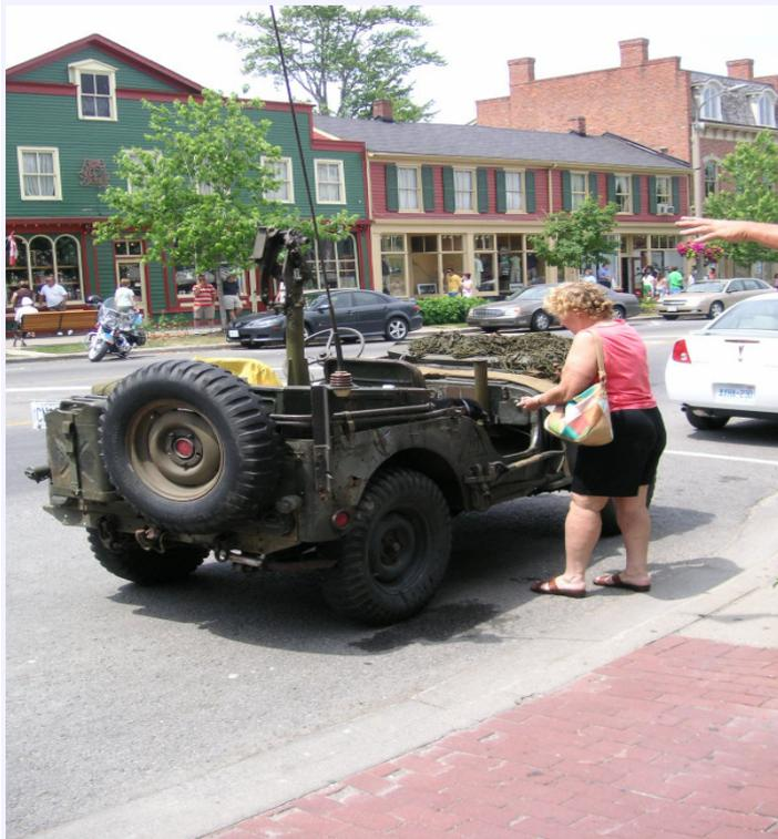
Das Bild zeigt einen „Willi's Jeep“ in VE (Canada) mit eingebautem CB Funk und einer Militärtypischen „Peitschen-Antenne“ ☺... sozusagen „Freiluft-Mobil-Funk“
